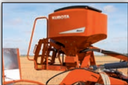
Zásobník osiva SH200 nebo SH500 o objemu 200 nebo 500 litrů pro setí mezplodin edním přejezdem během zpracování strniště.
