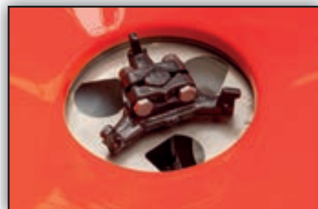
Čechrač zajišťuje rovnoměrný tok hnojiva.
