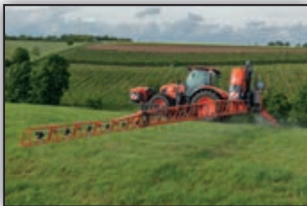
Boom Guide - ISOBUS kompatibilní postřikovač s ultrazvukovým vyrovnáváním ramen.
