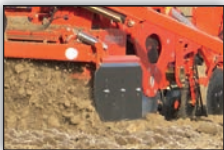
Plovoucí boční deflektory s ochranou proti přetížení zajišťují plynulý chod a zamezují tvorbě hrůbků mezi jednotlivými jízdami.
