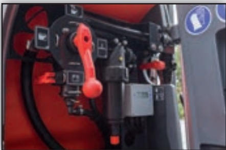
Ovládací panel Easy Set dělá život snazší díky intuitivnímu ovládání. Dva samostatné ventily – jeden sací a jeden tlakový.
